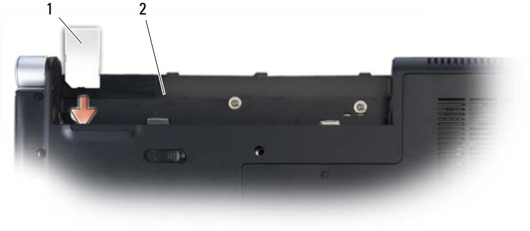
1 SIM 2 Compartimento de la batería
